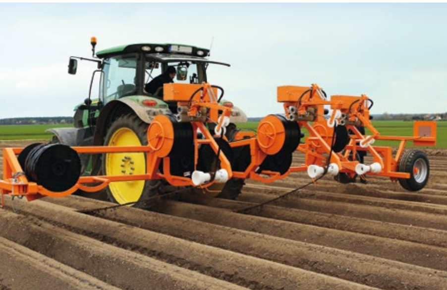
NETAFIM-Bergetechnik für Tropfrohre mit drei Hebe- und Wickeleinheiten
