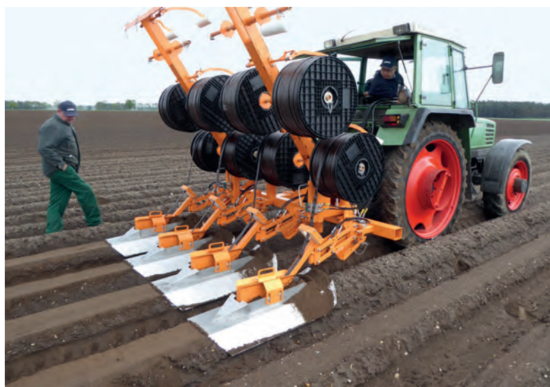
Die Verlegung der Tropfschläuche kann schlagkräftig nach dem Pflanzen in einem separaten Arbeitsgang oder direkt beim Pflanzen erfolgen. Foto: Buch
