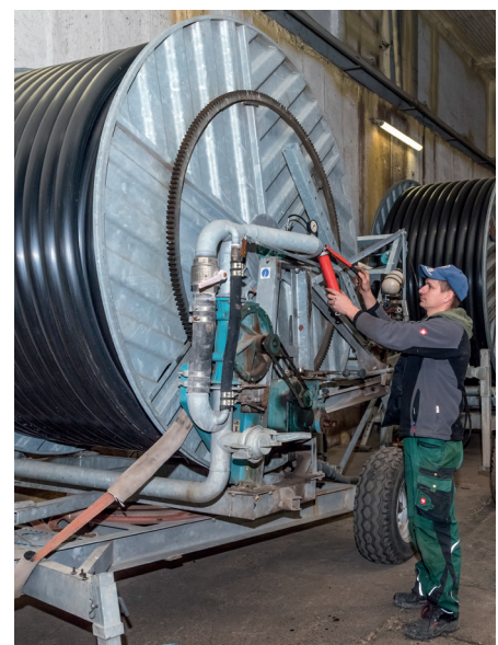
Mitarbeiter Nico Baumgart bei Wartungsarbeiten an einer Schlauchtrommel-Beregungsanlage.
